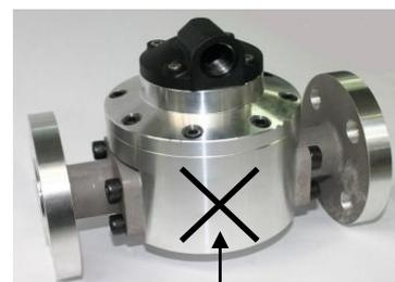
При неправильной установке вес роторов будет давить на основание измерительного прибора
