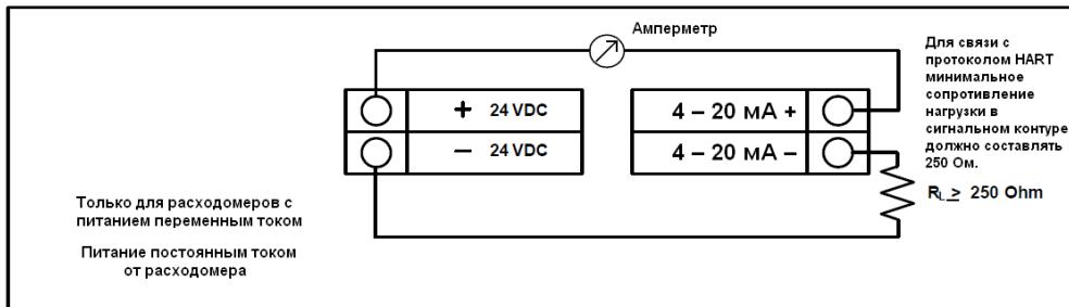
Рисунок 2-29. Изолированный выход 4 – 20 мА с питанием от расходомера
