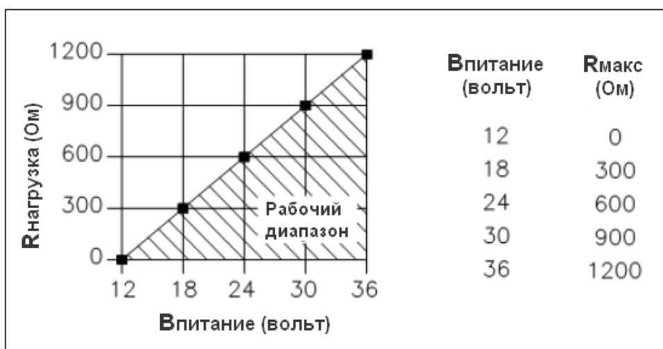
Рисунок 2-26. Зависимость сопротивления нагрузки от входного напряжения
