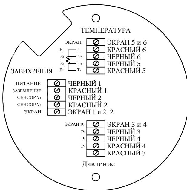
Рисунок 2-36. Распределительная коробка расходомера с питанием высокой мощности
