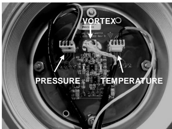
Рисунок 5-2. Электрические присоединения платы питания сенсора от удаленного источника напряжения
