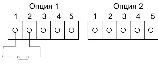
Рисунок 2-41. Подключение optionalного входа сигнала замыкания контактов
