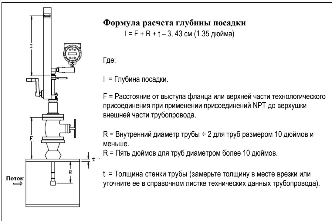
Рисунок 2-8. Определение глубины посадки (расходомеры с монтажным приспособлением)
