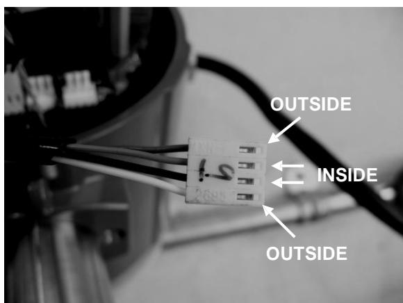
Рисунок 5-5. Разъем датчика давления
