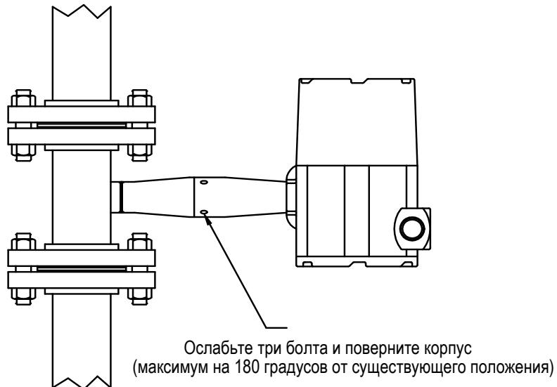
Т 2-13. Регулировка корпуса
