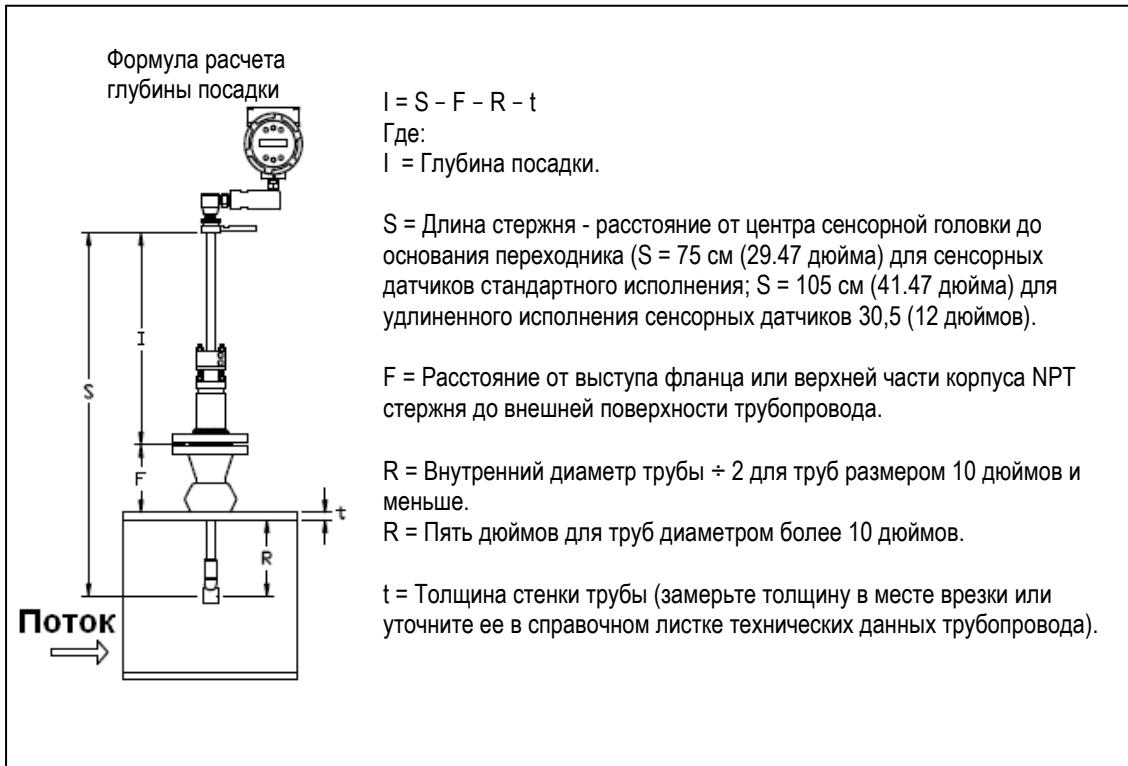
Рисунок 2-11. Определение глубины посадки (расходомеры без монтажного приспособления)
