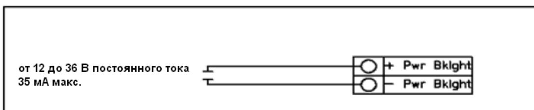
Рисунок 2-19. Подключение подсветки посредством внешнего источника питания
