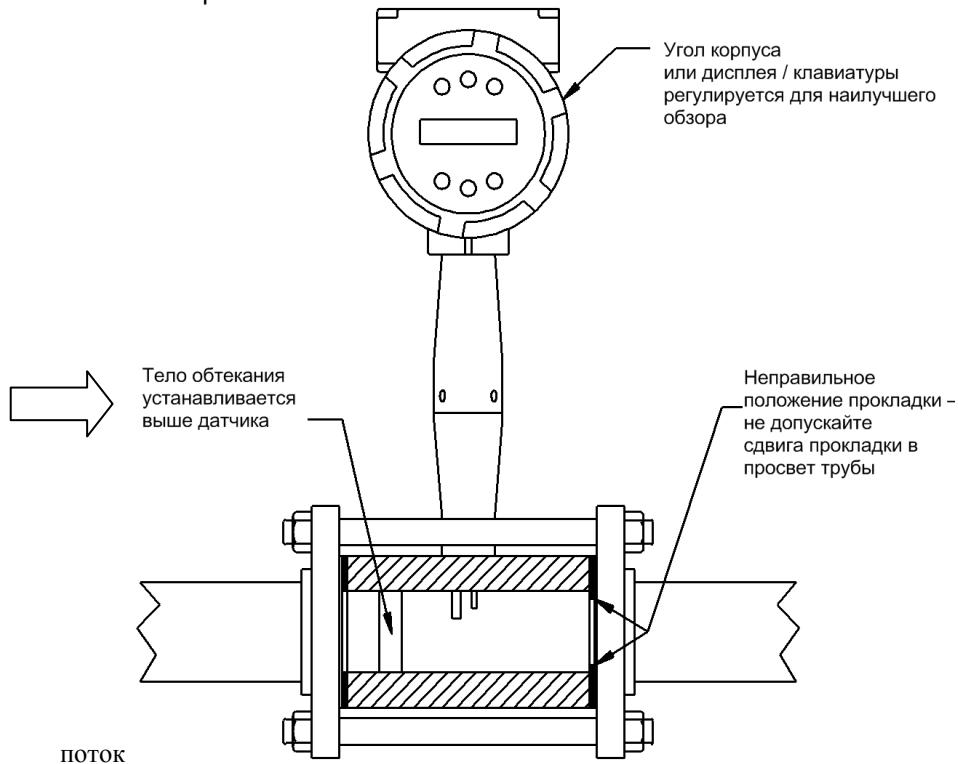
Рисунок 2-3. Установка вейферного расходомера
