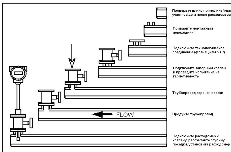
Рисунок 2-5. Последовательность действий при горячей врезке
