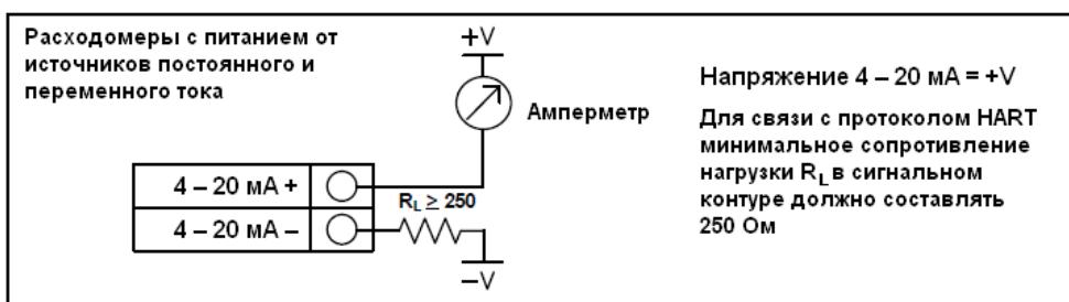
Рисунок 2-27. Подключение изолированного выхода 4 – 20 мА к внешнему источнику питания
