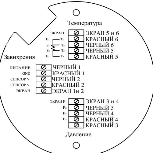
Рисунок 2-21. Распределительная коробка массового расходомера с питанием по сигнальному контуру
