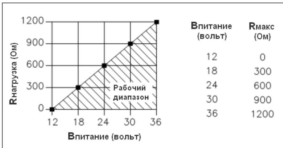
Рисунок 2-16. Зависимость сопротивления нагрузки от входного напряжения
