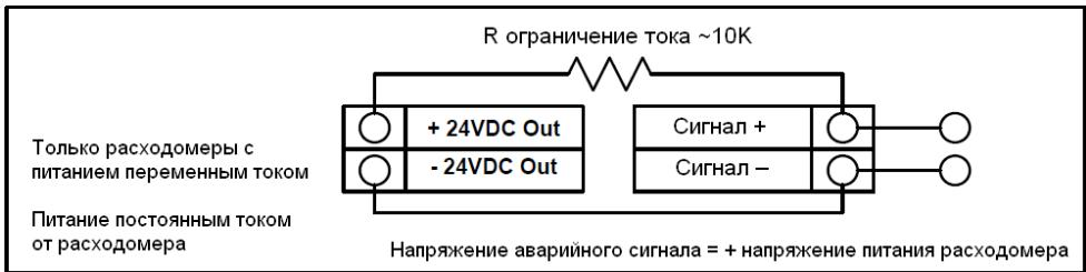
Рисунок 2-35. Питание изолированного выхода аварийного сигнала постоянным током от расходомера
