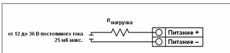
Рисунок 2-15. Подключение к источнику питания постоянного тока
