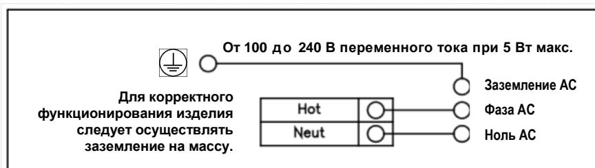
Рисунок 2-23. Подключение к источнику питания переменного тока
