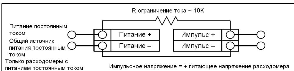
Рисунок 2-31. Питание неизолированного импульсного выхода входным напряжением расходомера
