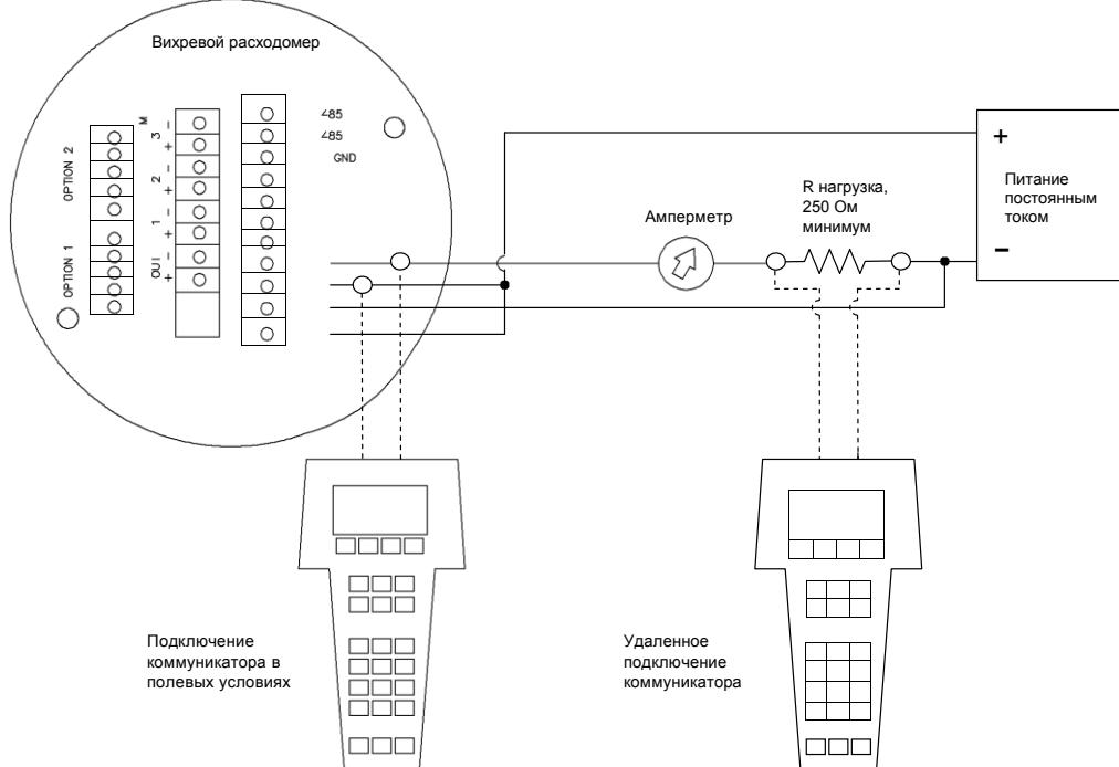
Рисунок 4-2. Подключение к расходомеру с питанием постоянным – током (HART)
