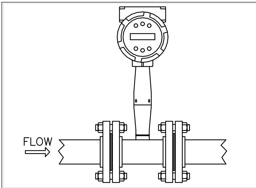
Рисунок 1-1. Многопараметрический вихревой расходомер последовательного соединения
