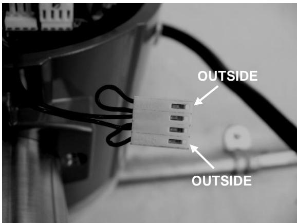
Рисунок 5-4. Разъем датчика температуры
