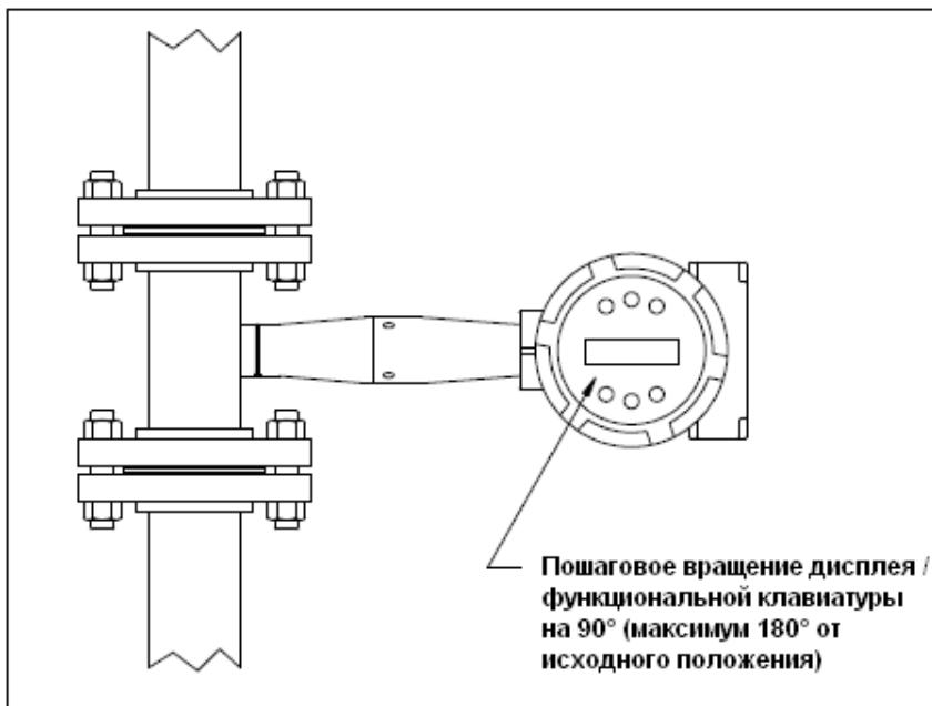
Рисунок 2-12. Регулировка точки просмотра дисплея / функциональной клавиатуры
