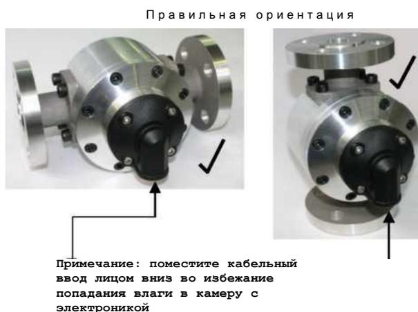
Жидкость может попадать в счетчик как из горизонтального, так и из вертикального положения. Для вертикального монтажа наиболее распространена ориентация для жидкости, поднимающейся через счетчик (например, снизу вверх), для содействия воздуху или выведения увлеченного газа. Работа счетчика не зависит от направления потока жидкости, поэтому на нем нет отметок о входе или выходе.
