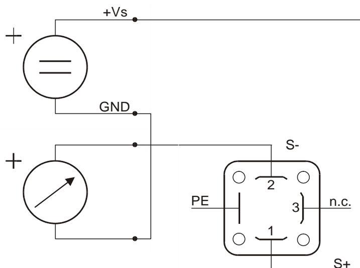
(PE – защитное заземление)
