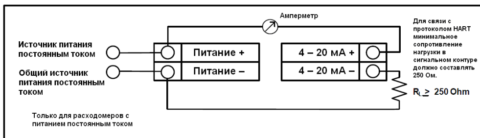
Рисунок 2-28. Подключение неизолированного выхода 4 – 20 мА к входному питанию расходомера
