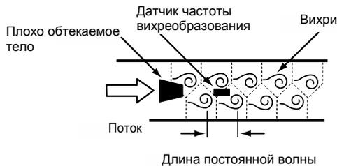
Принцип измерения основан на так называемой «дорожке Кармана». Поток измеряемой среды обтекает тело специальной формы, в результате чего позади тела обтекания возникает регулярная вихревая цепочка.
