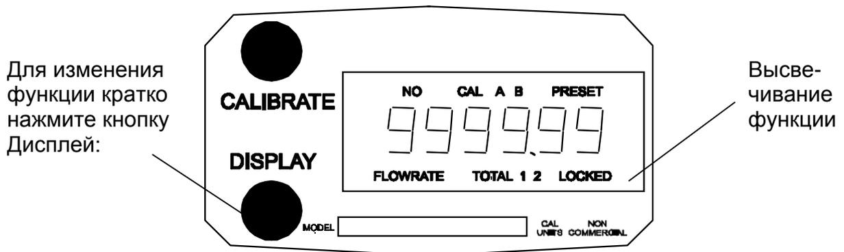
Все операции легко осуществляются с помощью двух кнопок на передней панели. Большинство функций выполняются кнопкой Display (Дисплей), кнопка CALIBRATE (КАЛИБРОВАТЬ) предназначена для калибровки различных типов жидкости. Дисплей ЖКД показывает текущую функцию или текущее состояние прибора. Простым нажатием кнопки DISPLAY одна за другой высвечиваются различные возможности измерения:
