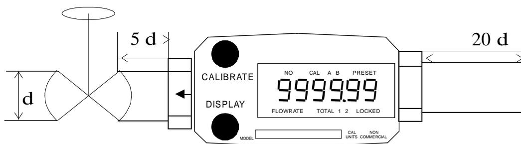
Клапаны или контрольные клапаны необходимо устанавливать с выходной стороны прибора. Модель EDM можно монтировать в любом положении. Для достижения наилучшей точности EDM следует калибровать в установленном положении с наличием измеряемой жидкости; через определенные интервалы времени прибор нужно проверять. Устанавливайте модель на расстоянии, по меньшей мере, 15 см от электрических приборов.
