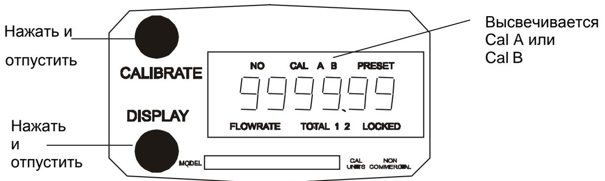
Если на ЖКД дополнительно выводится признак NO, значит, не была проведена эксплуатационная калибровка. В этом случае суммирование выключается, чтобы избежать ошибок в измерении.
