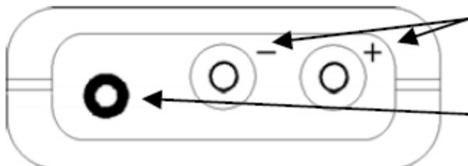
Разъем для датчиков давления: "+" = высокое давление, "-" = низкое давление
