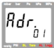
К прибору могут быть одновременно подключены до 10 портативных устройств серии HND при помощи соединительного кабеля (в зависимости от преобразователя, например HND-P...: позволяет подключить 5 устройств). Для обращения к каждому подключенному устройству, каждое устройство должно иметь индивидуальный базовый адрес. Например, для первого подключенного устройства можно выбрать 01, 11 для второго и так далее.
