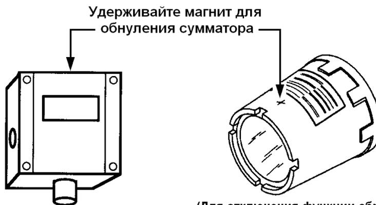
(Для отключения функции сброса при помощи магнита снимите переключку J2)
