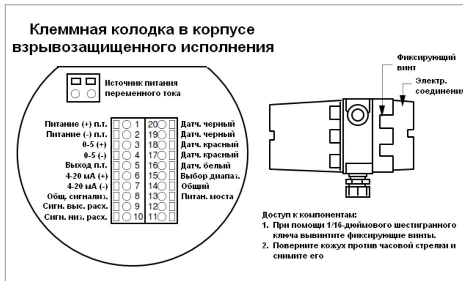
Рис. 2-5. Клеммная колодка взрывозащищенного корпуса
