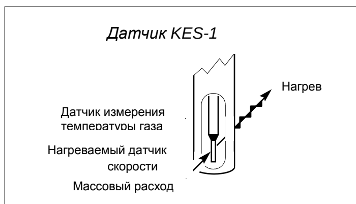
Рисунок 1-1. Монтаж датчика модели KES-1
