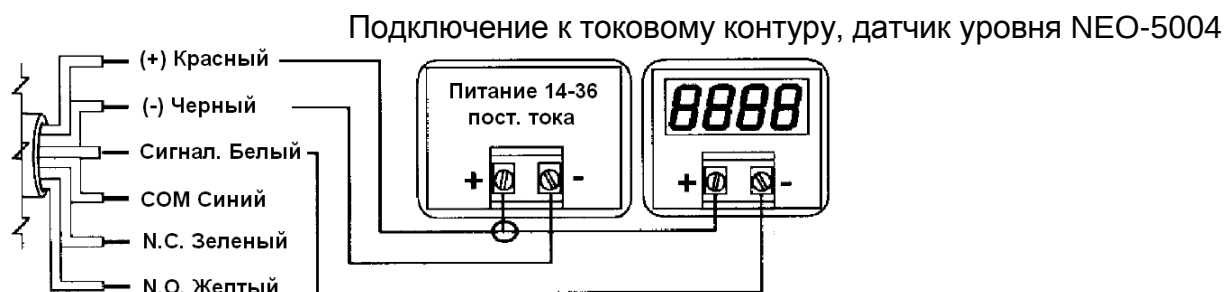
Изображение 4.2 Подключение NEO к контуру управления 4-20 мА
