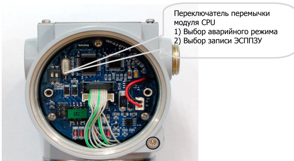
Изображение 4-3. Переключатель перемычки аварийного режима, записи ЭСППЗУ в модуле CPU
