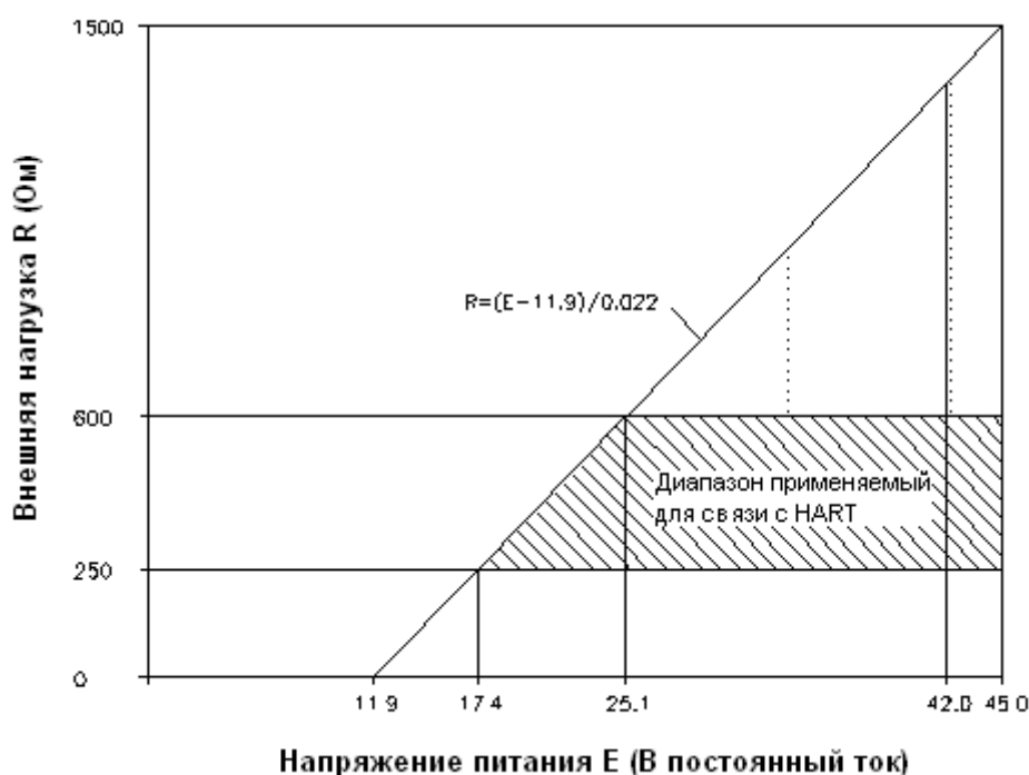
Изображение 6-5. Электропитание интеллектуального датчика давления модели PAS
