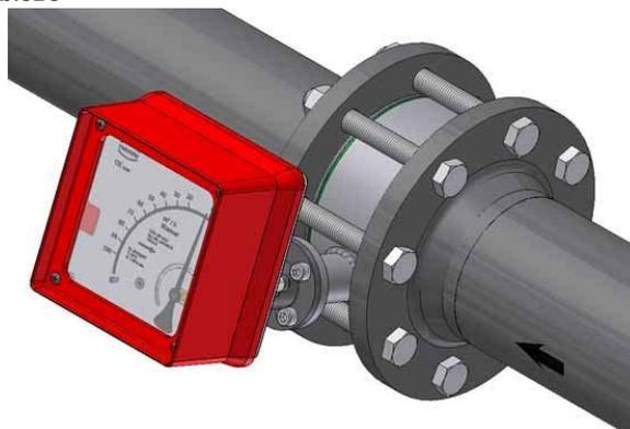
**Вертикальный монтаж; направление потока сверху вниз**
