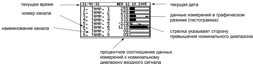
Рис. 6.20. Режим отображения данных «перечень каналов». Параметр «опций перечня каналов» установлен на «гистограммы».
