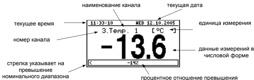
Рис. 6.9. Превышение номинального диапазона в «одноканальном» режиме.
