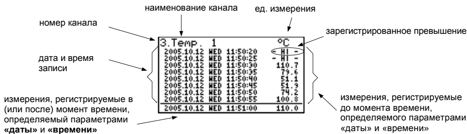
Рис. 6.12. Режим отображения данных «перечень измерений».
