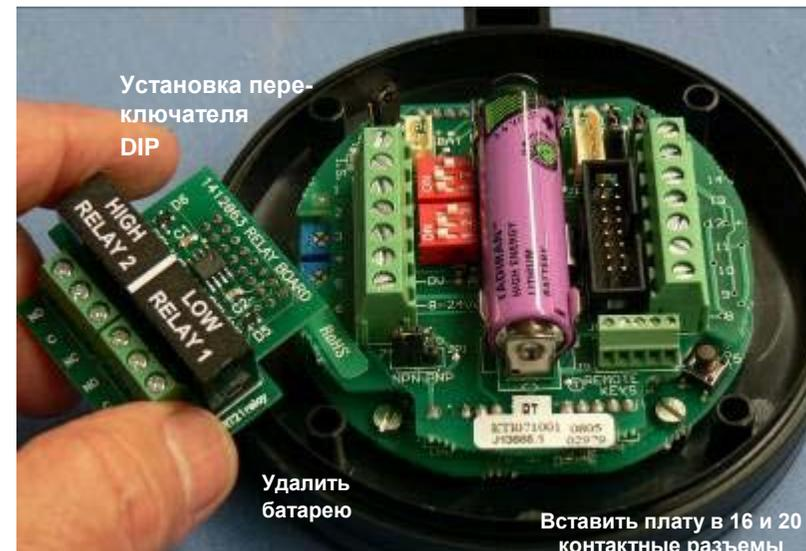
Плата релейного выхода контроля с 2 реле SPCO показана с ZOD-Z3, Контакты N/O установлены на 5А и контакты N/C на 3А max..
